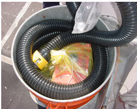
Un motor de bomba de achique es protegido por ZERUST® ICT®510-C Bolsa para Metales Ferrosos. Esta sin corrosión y lista para usarse.
